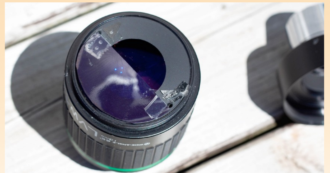
Le filtre coloré est installé sur le diaphragme.
